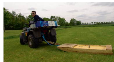
Veldwerk is efficiënt uit te voeren met sensoren op een quad.
