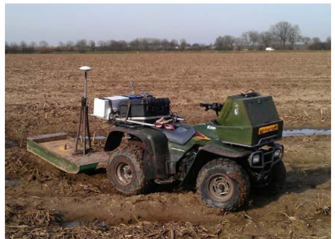
FIGUUR 1: HET UITVOEREN VAN DE GEOFYSISCHE METING MET GAMMASPECTROMETER EN GRONDRADAR.
