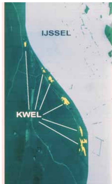
Kwel – piping – vormt een probleem. Hier een overzicht van kwelplaatsen van hoogwatergebied (1993) IJssel, linkerover, Wilp, polder de Nijenbeker en Wilpsche klei. (Bron: beeldbank RWS)
